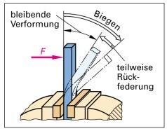
Bild 7: Elastisch-plastische Verformung eines Stabstahls
