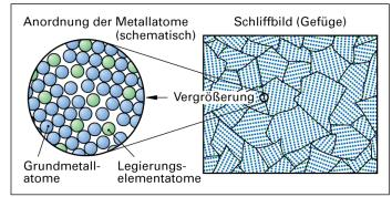
Bild 31: Innerer Aufbau einer Mischkristall-Legierung
