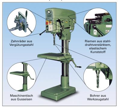
Bild 4: Werkstoffe der Bauteile einer Bohrmaschine
