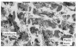
Abb.37: Temperrohguss (2,8% C) nach rascher Abkühlung. M500:1
