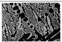
Hat die Eisenschmelze 4,3% C, so erstarrt sie zu einem Gefüge, das vollständig aus Ledeburit besteht. Es ist ein feines Gemenge aus Zementitkristallen und Perlitbereichen. (Abb.39)
