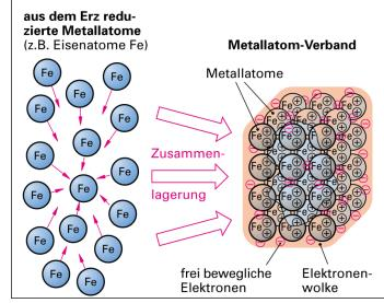
**Bild 21:** Entstehung der Metallbildung (Beispiel Eisen)
