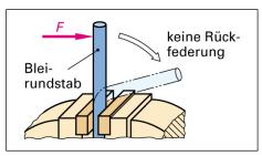
Bild 6: Plastizität eines Bleistabes
