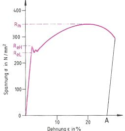
**Bild 15:** σ,ε-Diagramm mit ausgeprägter Streckgrenze
