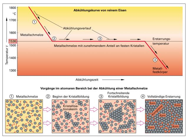
Bild 25: Abkühlungskurve und kristalline Vorgänge in einer Metallschmelze
