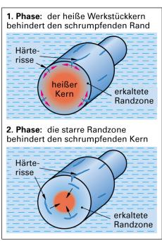
**Bild 50:** Entstehung von Härteverzug und Härterissen
