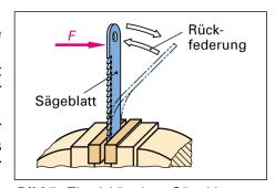
Bild 5: Elastizität eines Sägeblattes
