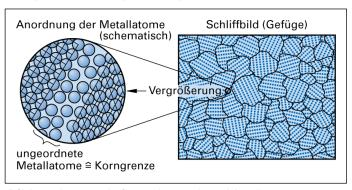
Bild 29: Innerer Aufbau eines reinen Metalls
