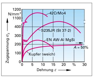
**Bild 16:** Spannungs-Dehnungs-Diagramm einer Aluminiumlegierung ohne ausgeprägte Streckgrenze
