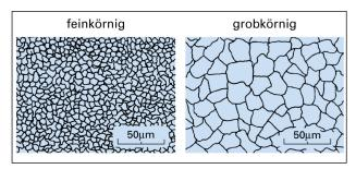
Bild 28: Gefüge mit unterschiedlichen Korngrößen
