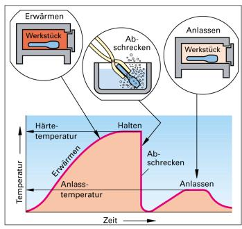
Bild 44: Temperaturverlauf beim Härten
