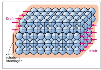
**Bild 22:** Plastische Verformung eines Kristalls durch Verschieben einer Metallatomlage
