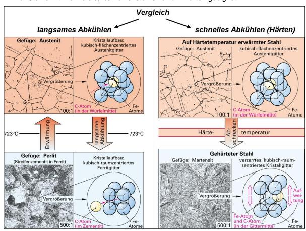
Bild 46: Gefügeumwandlung beim langsamen Abkühlen und beim Abschrecken (Härten)
