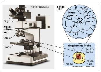
Bild 26: Sichtbarmachen eines Schliffbildes
