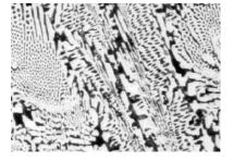
In der technischen Praxis erstarren Eisen-Werkstoffe mit einem Kohlenstoffgehalt über 2,06 % nach einem **Eisen/Graphit - Eisen/Zementit-Mischsystem**, da sie einen erheblichen Siliciumgehalt besitzen.
