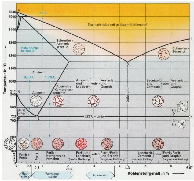
Abb.40: Eisen-Kohlenstoff-Zustandsschaubild und Gefügebereiche kohlenstoffhaltigen Eisens
