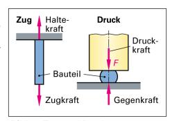
Bild 9: Zug- und Druckbeanspruchung
