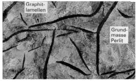
Abb.36: Graphit-Lamellen im Grauguss GG-20 (3,5% C) mit Si-Gehalt nach langsamer Abkühlung. M500:1
