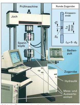
Bild 12: Zugversuch auf der Universalprüfmaschine
