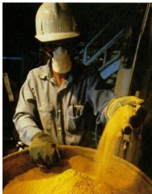
Bei der Energiegewinnung durch Kernspaltung ist es deshalb üblich, das gewonnene Natururan **anzureichern**. Darunter versteht man, dass die Konzentration des U 235 im Kernbrennstoff auf 2,5 bis 4 % erhöht wird. In einer ersten Anreicherungsstufe am Erzlagerort entsteht pulverförmiges „Yellowcake“ (Abb.10), ein Gemisch von Uranverbindungen. Aus zwei Tonnen Erz enthält man einen Kilogramm Yellowcake.
